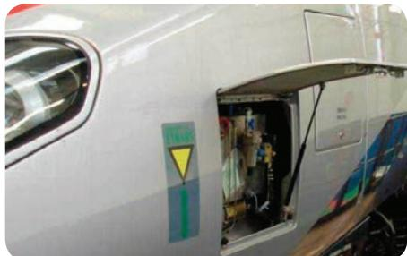
Эти двухмагистральные системы смазывания в основном применяются на больших локомотивах, высокоскоростных поездах со шпиндельными головками, но также и в других областях, где для целей техобслуживания ёмкость должна вмещать более семи литров смазки.
