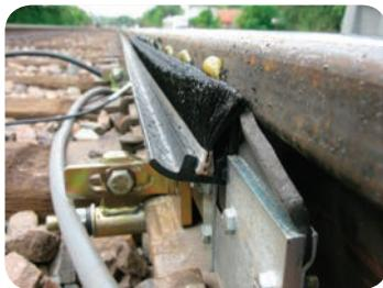
Смазочная рейка оснащается встроенным устройством последовательного дозирования, подающего одинаковые объёмы смазочного материала в 12 выходных отверстий, через которые смазка равномерно наносится на поверхность рельса. Технология Lincoln последовательной подачи из
