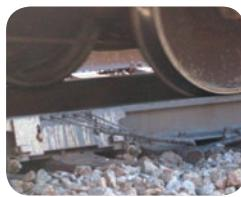
**Стационарные путевые системы смазки Lincoln** эффективно наносят постоянный и контролируемый объём смазки на рельс и поддерживают эту пластичную смазку или фрикционный преобразователь на месте, благодаря чему колёса захватывают смазочный материал и переносят его по кривой пути. Ассортимент продукции включает решения для поверхности колеи, головки рельса и удерживающего рельса.
