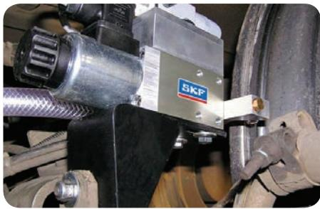
Системы SKF EasyRail Airless подходят для трамваев, лёгкого железнодорожного транспорта и метро, где невозможна подача сжатого воздуха.
