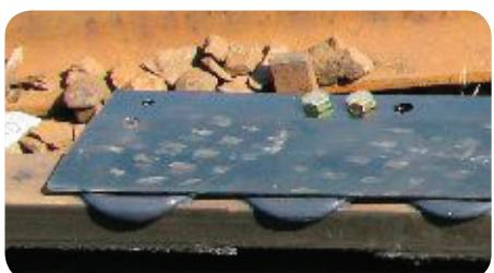
Система использует технологию подачи из насоса в смазочный канал для дозирования точного объема смазочного материала в
