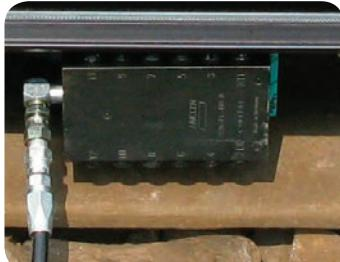
насоса в смазочный канал обеспечивает подачу одинакового объёма пластичной смазки в каждый канал.
