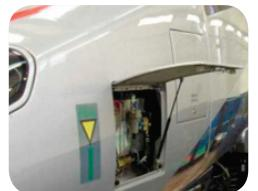
**Устанавливаемые на подвижном составе системы смазки SKF EasyRail** для смазывания гребня колеса и, соответственно, головок рельсов устанавливаются на первой колесной паре передней тележки головного вагона. Устанавливаемые на подвижном составе системы смазки доказали универсальность и эффективность применения в железнодорожной отрасли благодаря изменяемым настройкам.
