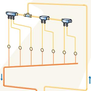
Циркуляционная система смазки маслом
